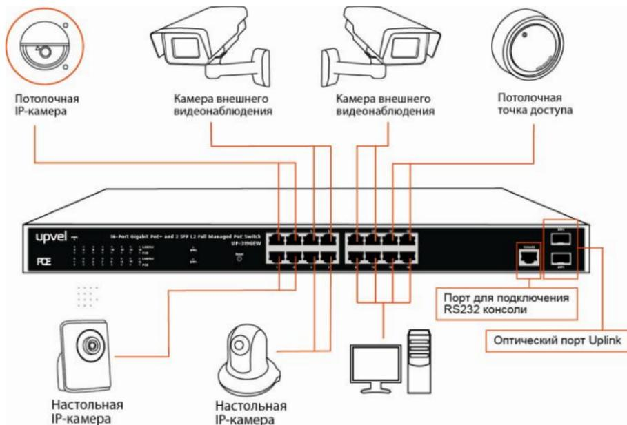
UTP/STP категории 5, 5e или 6. Порты коммутатора автоматически согласуют необходимые параметры (MDI/MDI-X, скорость соединения, дуплексный/полудуплексный режим) с Ethernet-интерфейсами подключенных устройств.
